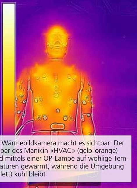
Die Wärmebildkamera macht es sichtbar: Der Körper des Manikin «HVAC» (gelb-orange) wird mittels einer OP-Lampe auf wohlige Temperaturen gewärmt, während die Umgebung (violett) kühl bleibt
