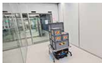
Autonome mobile Roboter, die per Funk die Schiebetüren öffnen, fahren automatisch in die Materialschleuse ein
