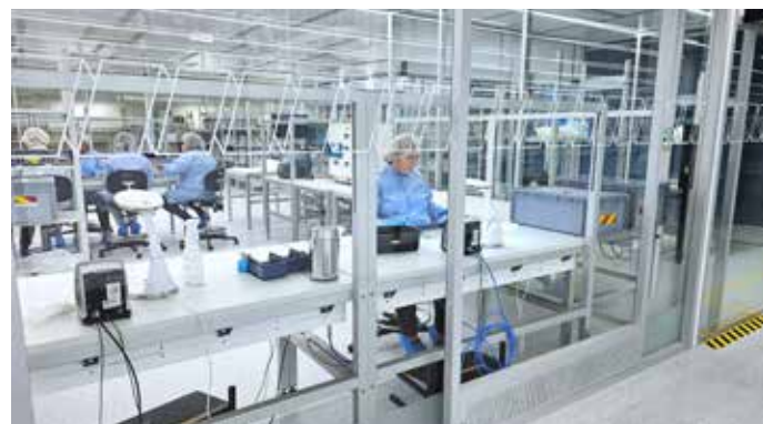
Vollverglaste Umluftwände sorgen für Tageslicht und Einsicht bei der Herstellung der Endoskope
