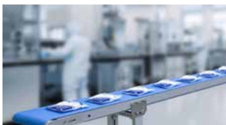
Reinraumförderer für hohe Ansprüche an die technische Sauberkeit, zertifizierbar nach ISO-Norm 14644 Bild: MK Technology Group
