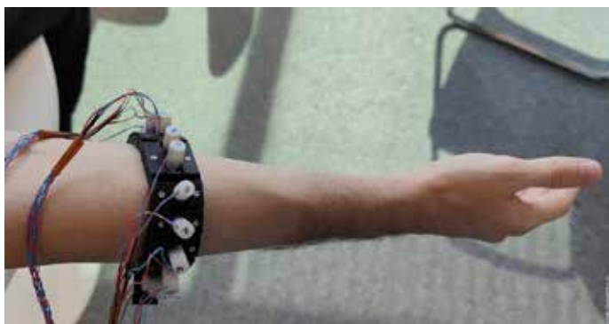
Sensorarmband: Demonstrator eines Sensorarmbands, mit dem an Probanden Messungen zur Handbewegungserkennung durchgeführt wurden. © FAULHABER
