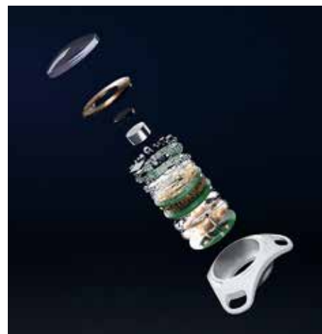
Komplexe Funktionalität auf kleinstem Raum: Das verkapselte Mikroimplantat beinhaltet eine achtlagige Platine.
