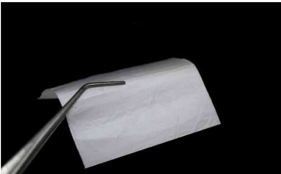
Elektroverspinnene Renacer®- Membran (5 x 5cm) Bilder: Fraunhofer ISC
