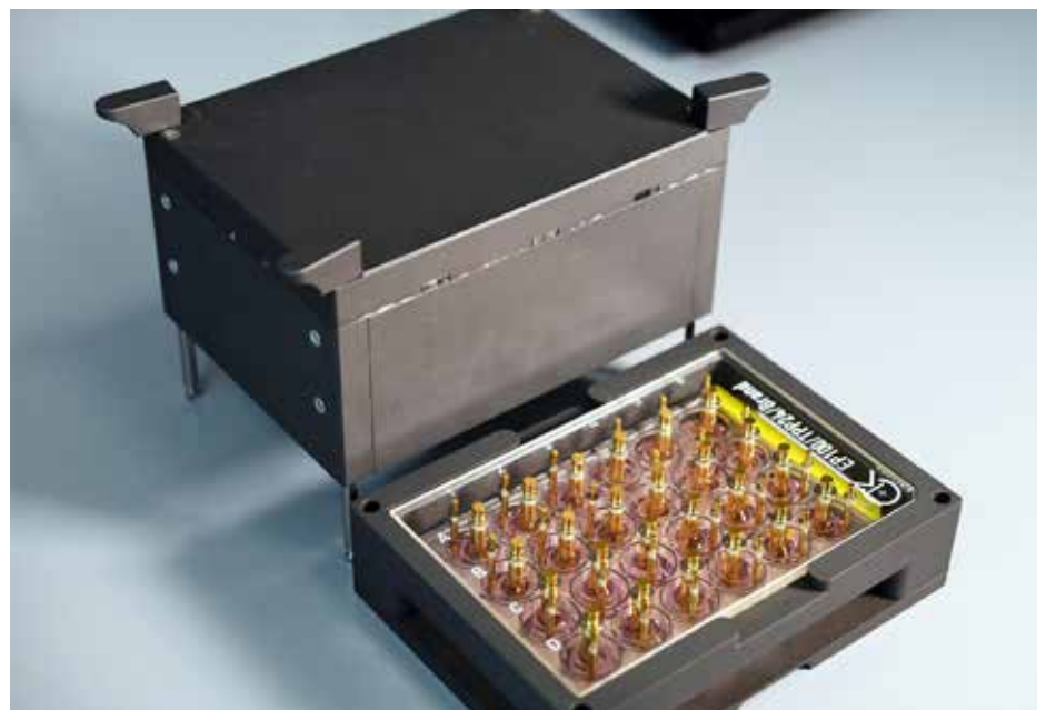
Aufgrund seiner geringen Grösse lässt sich das mobile Impedanzspektrometer problemlos zur Zellkulturbank mitnehmen Bilder: Fraunhofer ISC
