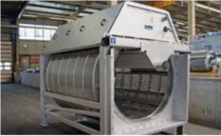
Mit diesen Mikrosieben lässt sich der organische Kohlenstoff genauso effizient aus dem Abwasser abscheiden wie in den bisher üblichen Vorklärbecken, nur brauchen die Siebe deutlich weniger Platz. Foto: Huber, Eawag
