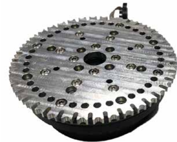
Revolvermagazin mit mehreren Kammern, in denen die biologischen Proben untergebracht sind.
