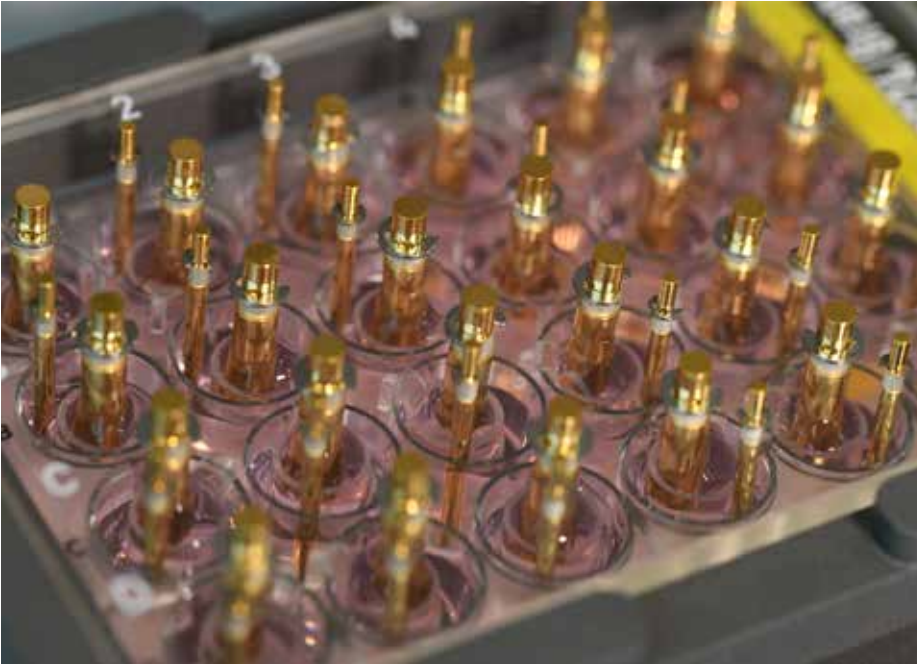
Zellkulturplatte mit Gewebekammern für 24 Cornea-Modelle Bilder: Fraunhofer ISC
