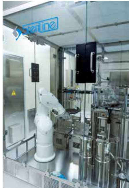
Detail der Roboter-Nestfüllmaschine (RNF2) von Steriline
