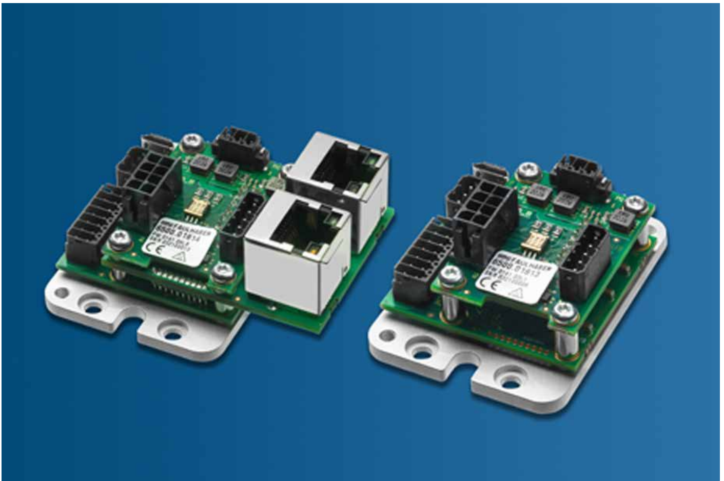
Neues Familienmitglied für den mittleren Leistungsbereich bis ca. 100 W: Der MC3603 eignet sich mit seinen kompakten Abmessungen gut für die Integration in Gerätebau- und Medizintechnik anwendungen. © FAULHABER
