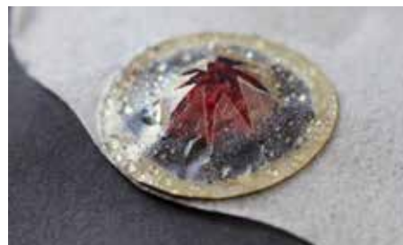
Sensor-Blüte: Der Schutzfilm aus Nanocellulose über dem Sensor öffnet sich wie eine Blüte, sobald er mit Feuchtigkeit in Berührung kommt – und der Sensor beginnt seine Arbeit. Bilder: Scott Zona / Empa
