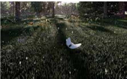
Vergängliche Datensammler: Bio-Gleiter werden von einer Drohne im Wald verteilt. Wenn sie den Boden erreichen, senden sie Umweltdaten, bis sie schliesslich von Bodenorganismen zersetzt werden. Illustration: Empa
