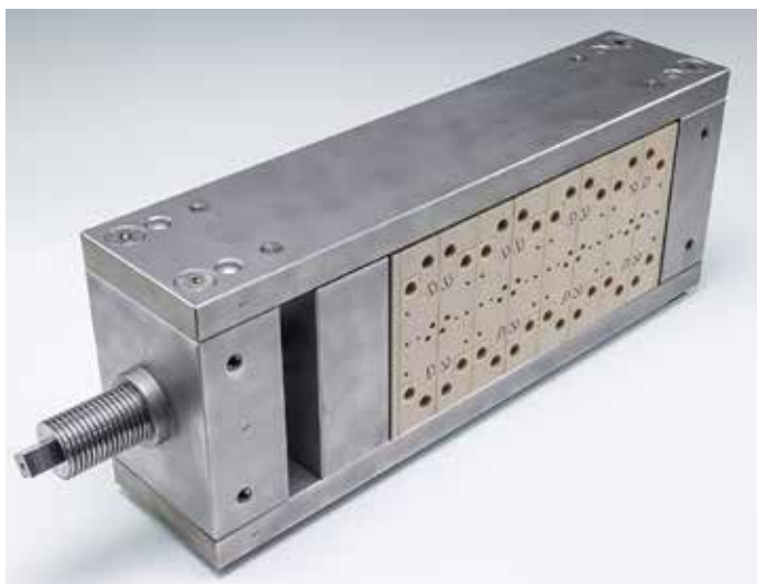
Prototyp des Screening-Moduls mit vier integrierten elektrochemischen Zellen Bild: © Fraunhofer IMM/Tobias Hang
