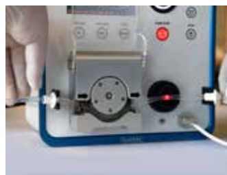
Die Irrigationspumpe erleichtert das Einlegen des Schlauchsets in die Schlauchpumpe und verfügt über einen Luftblasendetektor.
