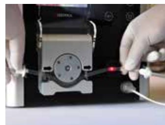
Die Irrigationspumpe erleichtert das Einlegen des Schlauchsets in die Schlauchpumpe und verfügt über einen Luftblasendetektor.
