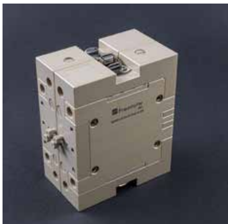
Modular aufgebaute elektrochemische Zelle für Screening-Aufgaben Bild: © Fraunhofer IMM/Tobias Hang
